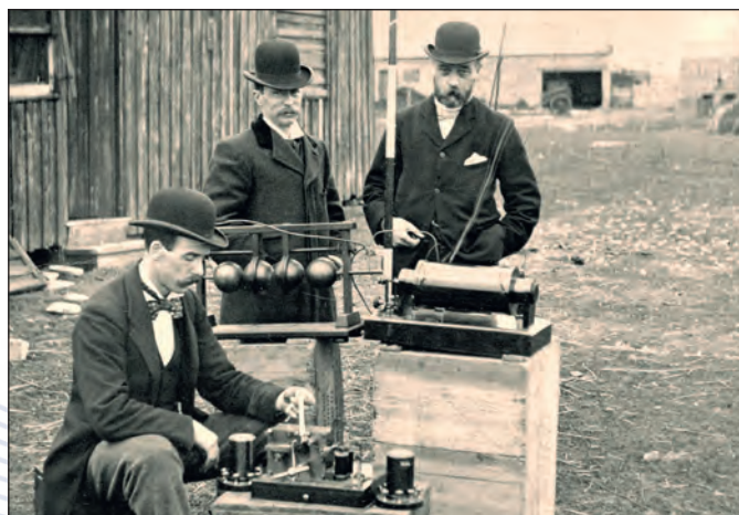
Ingenieure des britischen Postamts inspizieren während einer Vorführung auf der Insel Flat Holm die drahtlose Telegrafenausrüstung von Marconi.
