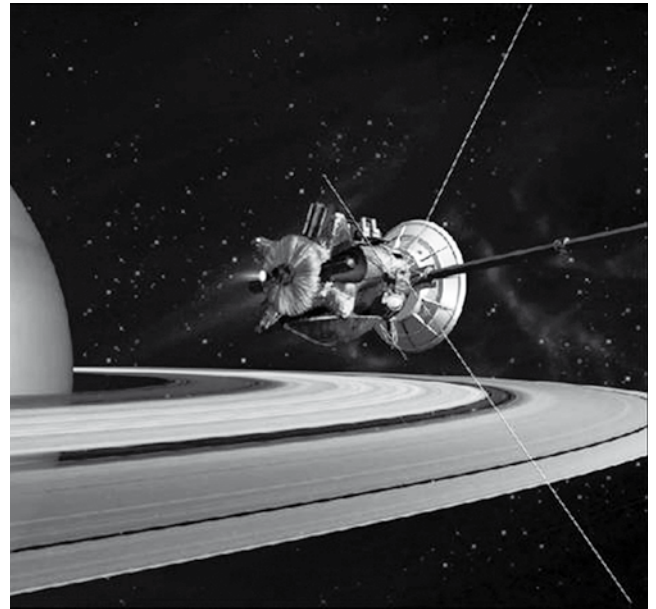
Abbildung 35: Cassini bremst in die Umlaufbahn des Saturns unmittelbar über den Ringen, indem sie das bord-eigene Triebwerk zündet, um von Saturns gigantischem Gravitationsfeld eingefangen zu werden. (künstlerische Darstellung der NASA)
