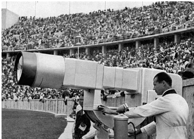
Rechts: Die Fernsehkamera Hs-293. Sie wiegt ein Hundertstel dessen, was andere Kameras in den 1930er Jahren wogen. (Bild aus der Sammlung des Autors)
